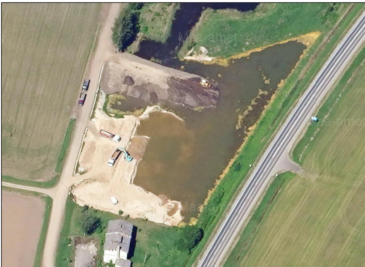
Foto 5. Maavara kaevandamine ning samaaegselt teostatav tehniline korrastamine (tagasi täitmine) Aluste kruusakarjääris (Maa-ameti kaldaerofoto 03.06.2019).
